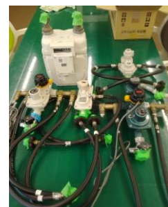
ガスメーター・自動切替装置 (清掃済)
